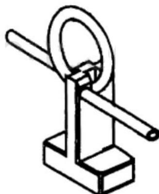
图 E.1 耐弯曲性试验工具及导尿管安装图
